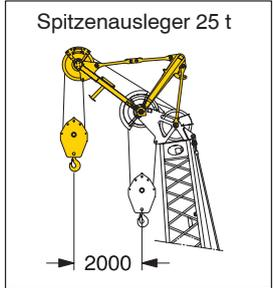
Der Spitzenausleger ist für maximal 25 t Traglast zugelassen. Die dazugehörige Traglasttabelle ist in der LMB programmiert.
