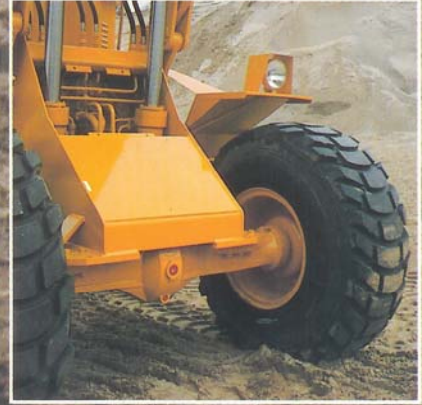
REMMEN Hydraulisch werkende volledig afgedichte ollebadlamellenremmen in de planeetnaven.
