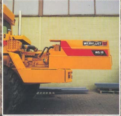
SCHUIF-MOTORKAP De bekende schuif-motorkap is nu uitgevoerd met 'n één-hantle vergrendelingsysteem.
