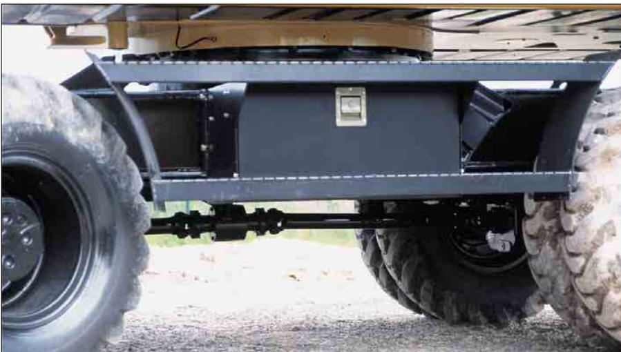
**Abstütz-Planierschild.** Mit dem Schild werden das Nivellieren des Baggers sowie Rückverfüllungen, Planier- und Räumarbeiten erheblich erleichtert. Darüber hinaus erhöht sich bei abge senktem Schild die Standsicherheit beim Graben und Heben. Mittels der praktischen Bolzenbefestigung lässt sich der Schild nach Bedarf vorn oder hinten anbauen. Im Lieferumfang ist ein stabiler Zylinderschutz enthalten.
