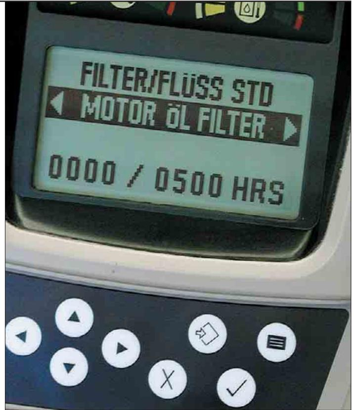
**Funktion.** Die grundlegende Funktion des neuen Multipro-Monitors für Mobilbagger besteht darin, Dieselmotor und Hydraulikpumpen so aufeinander abzustimmen, dass bei jeder Einsatzart maximale Produktivität, sparsamer Kraftstoffverbrauch, geringe Abgasemissionen und niedrige Schallpegel sichergestellt sind.
