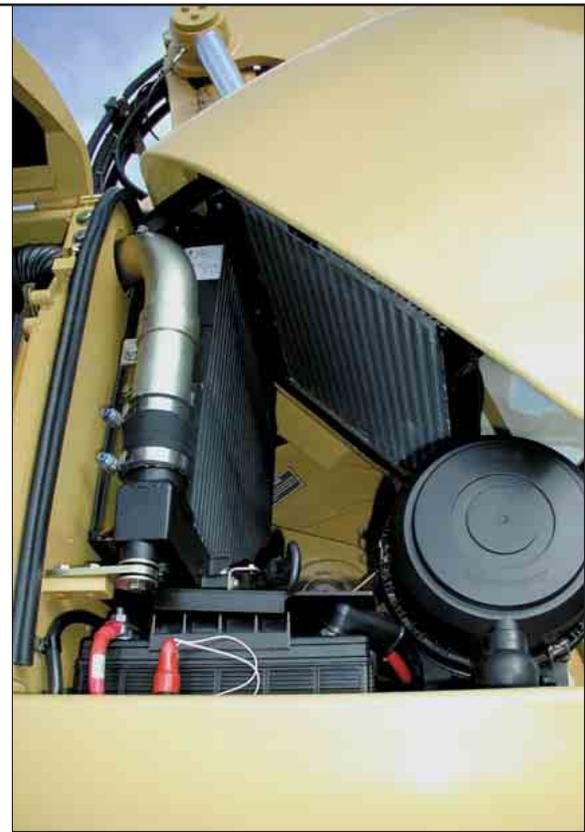
**Luftfilter.** Zum zweistufigen Trockenfiltersystem mit integriertem Vorreiniger gehören Haupt- und Sicherheitsfilterelemente, die einen hervorragenden Wirkungsgrad erzielen und ohne Werkzeug auszuwechseln sind. Bei übermäßiger Filterverschmutzung wird eine Kontrollleuchte im Multipro-Monitor aktiviert.
