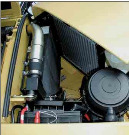
**Leistung/Umweltverträglichkeit.** Im M315C gibt der 3054E ATAAC eine Nennleistung (ISO 9249) von 91 kW (124 PS) bei 2000/min ab. Der Motor unterschreitet die zulässigen Abgasgrenzwerte gemäß 97/68/EG, Stufe II.
