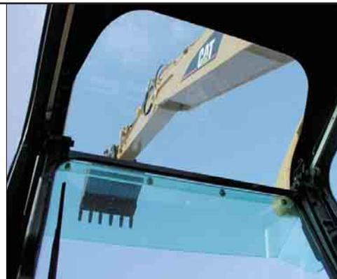
**Dachfenster.** Im vorderen Dachbereich der Kabine befindet sich ein groß dimensioniertes Fenster, das die Sicht bei Arbeiten in größeren Höhen wesentlich verbessert.
