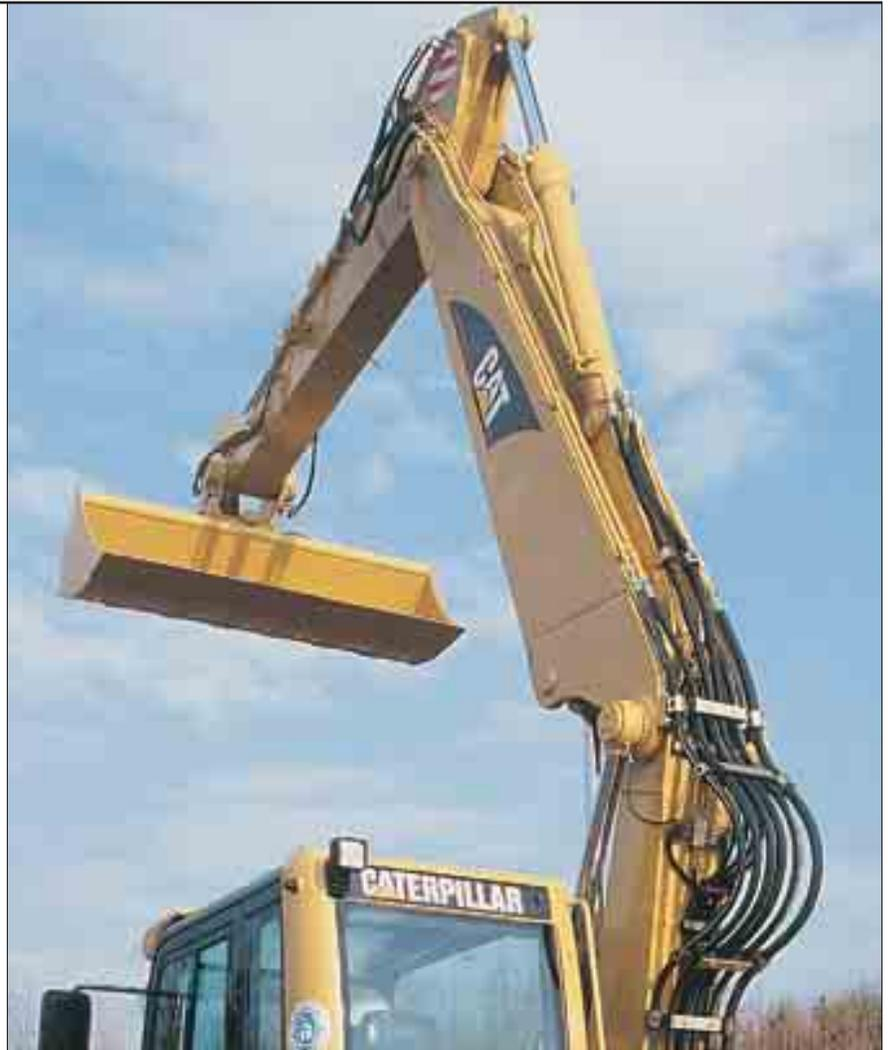
**Mitteldruckkreis.** Für hydraulische Anbaugeräte, die mittlere Betriebsdrücke erfordern, gibt es den M315C ab Werk mit einem zusätzlichen Mitteldruck-Hydraulikkreis.
