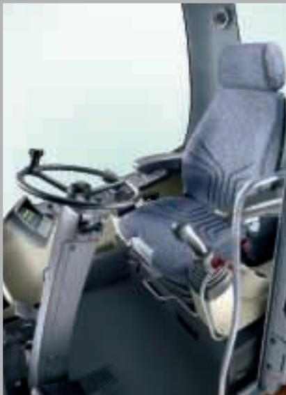
*Die neue Luftführung in der Kabine gewährleistet ein optimales Raumklima auch bei ungünstigsten Wetterbedingungen. Durch Schiebemechanismen im oberen und unteren Teil der Frontscheibe sowie einem Schiebefenster in der Fahrertür lässt sich die Luftzufuhr von außen individuell den Witterungsverhältnissen entsprechend regulieren.*
