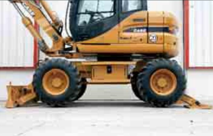
Mit dem zweistufigen Getriebe ist eine Fahrgeschwindigkeit von 33 km/h möglich. Die maximale Zugkraft in der unteren Fahrstufe beträgt 79 kN. Die Maschinen der Baureihe WX125 Serie 2 können mit Zweirad- oder Allradlenkung und Single- oder Zwillingsbereifung bestellt werden. In der Allradversion kann die Maschine im Hundegang-Modus schräg von Wänden oder Hindernissen weg bewegt werden. So wird der Oberwagen geschützt und das Risiko von Beschädigungen vermieden.
