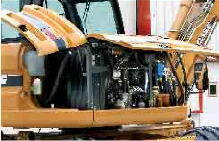
Der elektronisch geregelte Turbo-Diesel erfüllt die Vorschriften der EU-Abgasnorm Tier III. In Tests ergibt sich für den 112 PS (84 kW) starken Motor ein 12 % geringerer Kraftstoffverbrauch. Das System zur Überwachung und Regelung von Motordrehzahl und Hydraulikpumpe eröffnet vielfältige Einsatzmöglichkeiten bei hohem Durchsatz, gesteigerter Produktivität und mehr Tonnen pro Liter für den Kunden.
