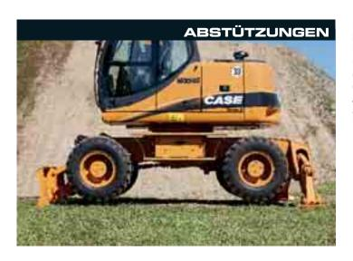
Dank des modularen Unterwagens der WX-Bagger von Case haben die Kunden die Wahl zwischen Abstützungen oder einem Planierschild oder einer Kombination von beiden. Abstützungen und Planierschild werden unabhängig voneinander bedient, um einen Ausgleich bei unebenem Gelände zu ermöglichen. Die optionalen "City"-Abstützungen mit ihren zahlreichen Abstützmöglichkeiten bieten vollständige Stabilität für Arbeiten auf engem Raum, wie z. B. entlang von Bürgersteigen oder Hindernissen.
