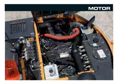
Beim WX145 kommt ein 4-Zylinder-Motor von Case mit einem äußerst sparsamen Verbrauch zum Einsatz. Dieser Motor, der die Anforderungen der Euronorm Tier 3 erfüllt, ist mit Turbolader und Ladeluftkühlung für eine bessere, saubere Verbrennung und eine hohe Leistung ausgestattet. Der Motor bietet eine maximale Zuverlässigkeit und Widerstandsfähigkeit. Die automatische Motorvorwärmung gewährleistet eine lange Lebensdauer bei minimalen Stillstandszeiten.
