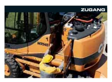
Trotz des reduzierten Heckschwenkradius der WX-Bagger von Case bleibt der Wartungssteg hinter der Kabine erhalten, der den Wartungstechnikern einen hervorragenden Zugang zu den Routinewartungspunkten bietet und einen sicheren Arbeitsbereich gewährleistet. Durch Hochklappen der Motorhaube erhalten Sie freie Sicht auf Motoroberseite, Zusatzsteuergeräte und Kühler.
