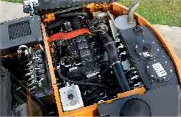
Beim WX165 kommt ein 6-Zylinder-Motor von Case mit sehr hohem Drehmoment und perfekter Leistung zum Einsatz. Dieser Motor, der die Anforderungen der Euronorm Tier 3 erfüllt, ist mit Turbolader und Ladeluftkühlung für eine bessere, saubere Verbrennung und eine hohe Leistung ausgestattet. Der Motor bietet eine maximale Zuverlässigkeit und Widerstandsfähigkeit. Die automatische Motorvorwärmung gewährleistet eine lange Lebensdauer bei minimalen Stillstandszeiten.
