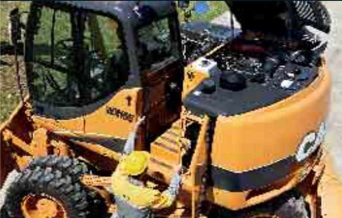
Trotz des reduzierten Heckschwenkradius der WX-Bagger von Case bleibt der Wartungssteg hinter der Kabine erhalten, der den Wartungstechnikern einen hervorragenden Zugang zu den Routinewartungspunkten bietet und einen sicheren Arbeitsbereich gewährleistet. Durch Hochklappen der Motorhaube erhalten Sie einen freien Blick auf Motoroberseite, Zusatzsteuergeräte und Kühler.
