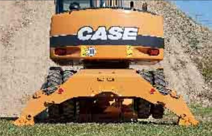
Dank des modularen Unterwagens der WX-Bagger von Case haben die Kunden die Wahl zwischen Abstützungen oder einem Planierschild oder einer Kombination von beiden. Abstützungen und Planierschild werden unabhängig voneinander bedient, um einen Ausgleich bei unebenem Gelände zu ermöglichen. Die optionalen „City“-Abstützungen mit ihren zahlreichen Abstützmöglichkeiten bieten vollständige Stabilität für Arbeiten auf engem Raum, wie z. B. entlang von Bürgersteigen oder Hindernissen.
