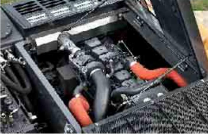
Beim WX210 kommt ein 6-Zylinder-Motor von Case mit sehr hohem Drehmoment und perfekter Leistung zum Einsatz. Dieser Motor, der die Anforderungen der Euronorm Tier 3 erfüllt, ist mit Turbolader und Ladeluftkühlung für eine bessere, saubere Verbrennung und eine hohe Leistung ausgestattet. Der Motor bietet eine maximale Zuverlässigkeit und Widerstandsfähigkeit. Die automatische Motorvorwärmung sorgt für eine lange Lebensdauer und weniger Stillstandszeiten.
