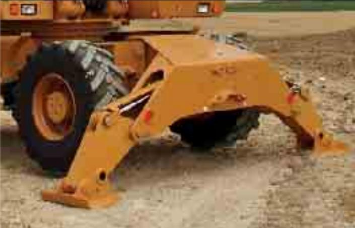
Dank des modularen Unterwagens der WX-Bagger von Case haben die Kunden die Wahl zwischen Abstützungen oder einem Planierschild oder einer Kombination von beiden. Abstützungen und Planierschild werden unabhängig voneinander bedient, um einen Ausgleich der Maschine bei unebenem Gelände zu ermöglichen.
