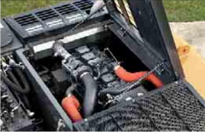
Beim WX240 kommt ein 6-Zylinder-Motor von Case mit sehr hohem Drehmoment und perfekter Leistung zum Einsatz. Dieser Motor, der die Anforderungen der Euronorm Tier 3 erfüllt, ist mit Turbolader und Ladeluftkühlung für eine bessere, saubere Verbrennung und eine hohe Leistung ausgestattet. Der Motor bietet eine maximale Zuverlässigkeit und Widerstandsfähigkeit. Die automatische Motorvorwärmung sorgt für eine lange Lebensdauer und weniger Stillstandszeiten.
