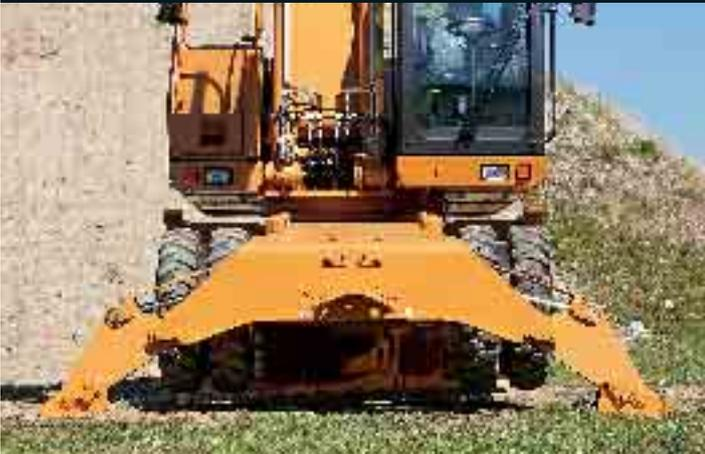
Dank des modularen Unterwagens der WX-Bagger von Case haben die Kunden die Wahl zwischen Abstützung oder einem Planierschild oder einer Kombination von beiden. Abstützung und Planierschild werden unabhängig voneinander bedient, um die Maschine in unebenem Gelände optimal horizontal ausrichten zu können.
