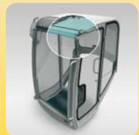
4 **Beide Scheibenteile** werden unter dem Kabinendach verwahrt. Sie müssen weder herausgenommen noch irgendwo gelagert werden. Die Beschädigungsgefahr ist gebannt.
