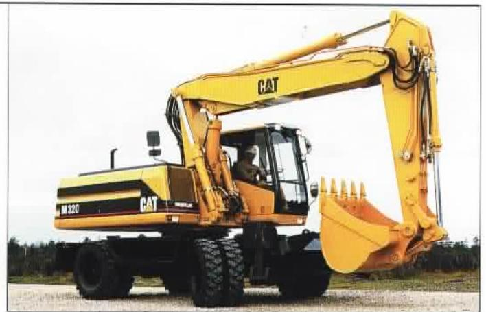
**Monoblockausleger.** Mit einer Länge von 5,65 m eignet sich dieser einteilige Auslegertyp bestens für alle Standardanwendungen und Hammereinsätze. Die großdimensionierten, verwindungssteifen Kastenprofile sind nach FEM konstruiert, um das Eigengewicht so weit wie möglich zu reduzieren.
