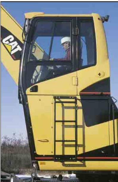
**Starre Kabinenerhöhung.** Die starre Erhöhung, lieferbar für Umschlag-Unterswagen (M322C MH) und Universal-Unterswagen (M318C MH/M322C MH), bietet eine äußerst stabile Basis für die Fahrerkabine. Mit einer Höhe von 1200 mm verschafft sie dem Maschinisten eine hervorragende Übersicht bei allen Arbeiten. Die an der Erhöhung angebrachte Leiter erlaubt ein sicheres, bequemes Ein- und Aussteigen. Falls erforderlich, kann die Fahrerkabine vor dem Transport der Maschine komplett abgebaut werden.
