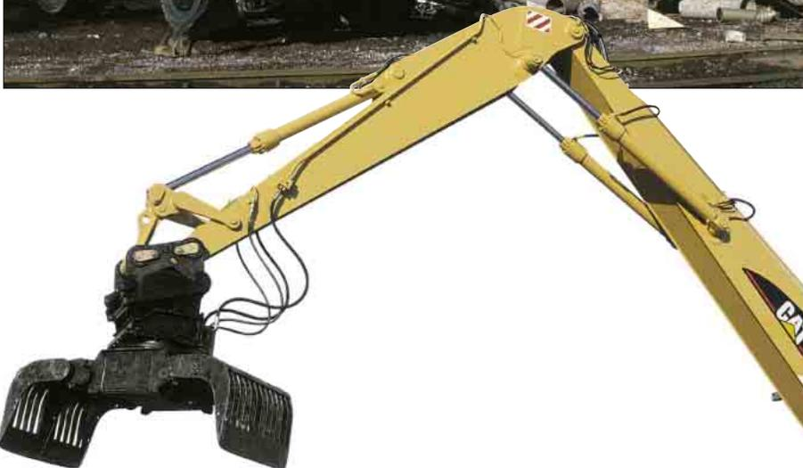
**Konstruktion.** Durch die konstruktive Optimierung der 6200 mm (M318C MH) bzw. 6800 mm (M322C MH) langen Umschlag-Ausleger konnte das Hubvermögen der Maschinen gesteigert werden. Die neuen Stiele besitzen zwei Seitenbleche, zwischen denen die Hydraulikleitungen geschützt verlegt sind.
