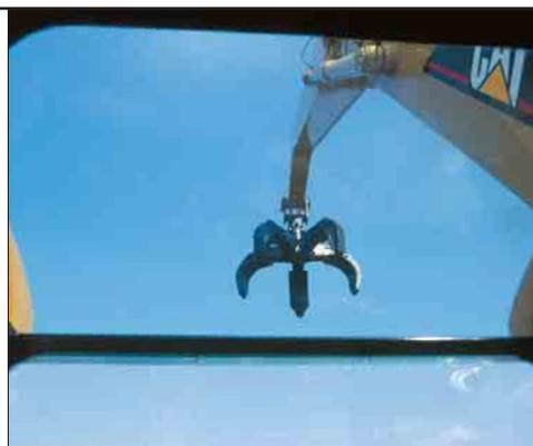
**Dachfenster.** Im vorderen Dachbereich der Kabine befindet sich ein groß dimensioniertes Fenster, das die Sicht beim Arbeiten in größeren Höhen wesentlich verbessert.
