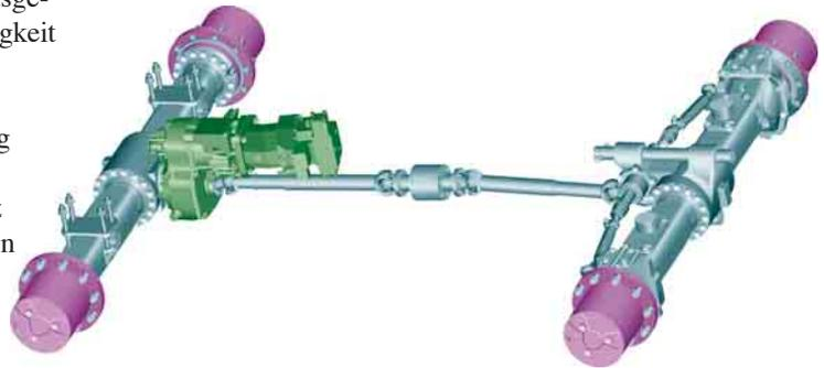
**Bremsen.** Die neu konstruierten Radbremsen wirken nicht mehr auf die Achswellen, sondern direkt auf die Achsnaben. Infolge dieser Änderung wird das Ruckeln beim Arbeiten mit freistehender Maschine vermieden. Die neuen Achsen erfordern weniger Wartung (Ölwechsel nur noch alle 2000 statt 1000 Betriebsstunden), sodass sich die Instandhaltungskosten reduzieren.
