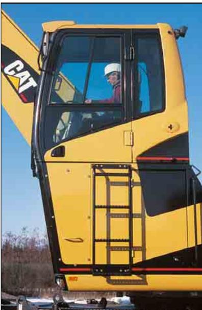
**Starre Kabinenerhöhung.** Mit einer Höhe von 1200 mm bietet die für M322C MH als Sonderausrüstung lieferbare starre Kabinenerhöhung eine hervorragende Übersicht bei allen Arbeiten. Die an der Erhöhung angebrachte Leiter erlaubt ein sicheres, bequemes Ein- und Aussteigen. Falls erforderlich, kann die Fahrerkabine vor dem Transport der Maschine komplett abgebaut werden.
