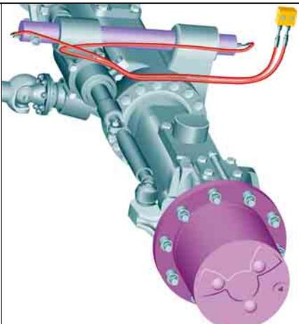
**Schmiernippel.** Zwei Schmiernippel für das Drehkranzlager und ein Schmiernippel für die Arbeitsausrüstung sind an einer zentralen Schmierstelle zusammengefasst, die sich gut geschützt im Motorraum befindet. Diese Fernschmiernippel erleichtern das Abschmieren der schwer zugänglichen Bauteile erheblich. Auch Pendelachsaufhängung und Abstütz-Planierschild werden über Fernschmiernippel am Unterwagen mit Fett versorgt.
