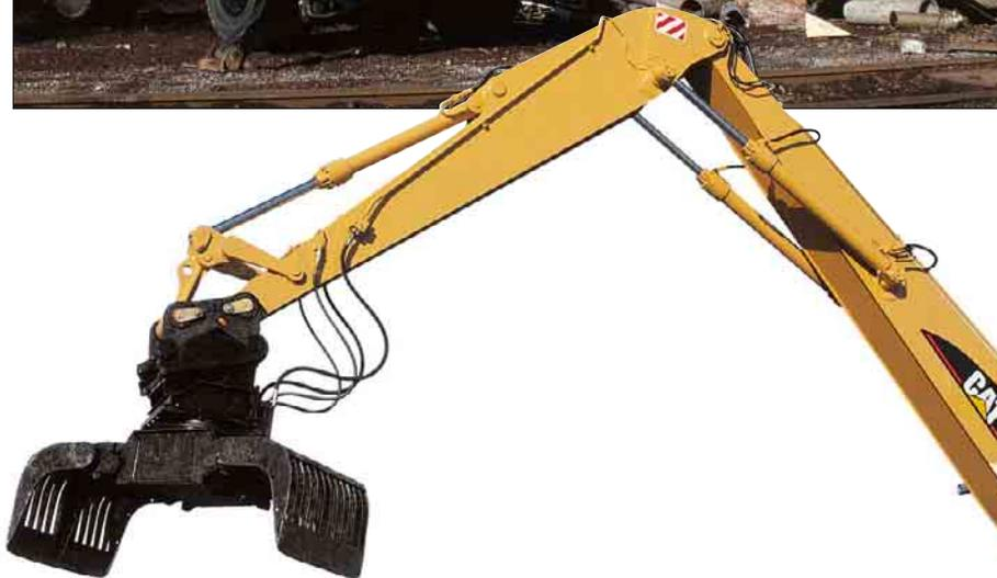
**Konstruktion.** Durch die konstruktive Optimierung der 6200 mm (M318C MH) bzw. 6800 mm (M322C MH) langen Umschlagsausleger konnte das Hubvermögen der Maschinen gesteigert werden. Die neuen Stiele besitzen zwei Seitenbleche, zwischen denen die Hydraulikleitungen geschützt verlegt sind.
