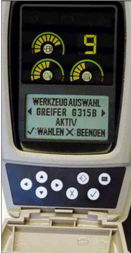
**Funktion.** Die grundlegende Funktion des neuen Multipro-Monitors für Mobilbagger besteht darin, die Leistung von Dieselmotor und Hydraulikpumpen so zu koordinieren, dass bei jeder Einsatzart maximale Produktivität, sparsamer Kraftstoffverbrauch, geringe Abgasemissionen und niedrige Schallpegel sichergestellt sind.
