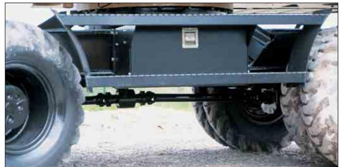
**Werkzeugkästen.** Zwischen den linken und rechten Trittstufen des Unterwagens ist jeweils ein abgedichteter, verschließbarer Werkzeugkasten angeordnet.
