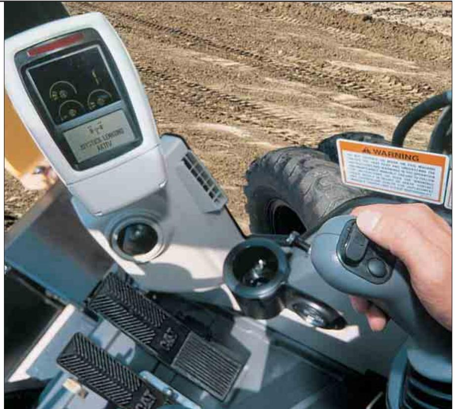
**Leistungsstufenwahl.** Drei wählbare Leistungsstufen erlauben dem Fahrer eine Anpassung von Motor- und Hydraulikleistung an die jeweilige Betriebssituation.
