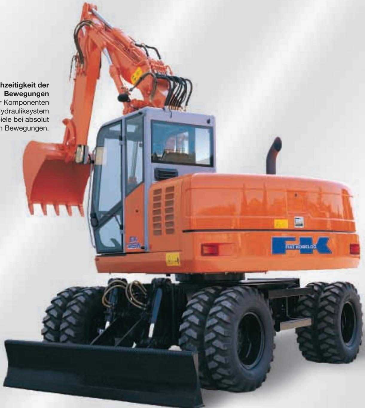
Der **kleine Heckschwenkradius** (1675 mm) und der schwenkbare Ausleger ermöglichen den Einsatz in sehr beengten Verhältnissen.
