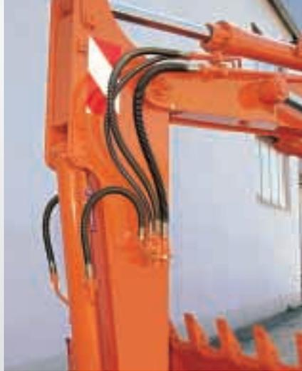
**Greiferverrohrung bis Mitte
