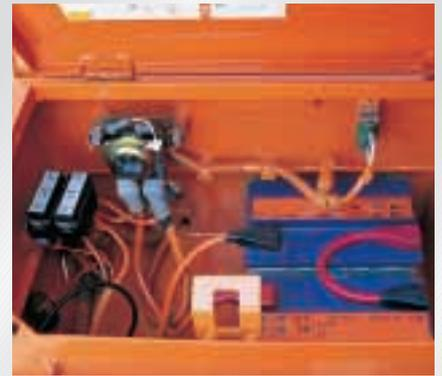
Leicht zugängliche Batterien, elektrische Batterieabschaltung.
