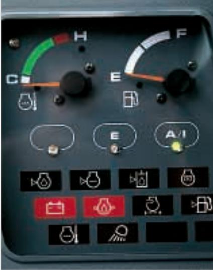
**Elektronische Füllstandskontrolle für Motoröl-, Kühlwasser- und Hydraulikölstand**
