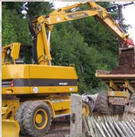
sich der Bagger leicht und exakt manövrieren lässt. Eine separate Pumpe sorgt für eine 100% unabhängige Schwenkfunktion. Zusammen mit dem leistungsstarken Motor sorgt das load-sensing System dafür, dass sich auch anspruchsvolle Aufgaben mit Leichtigkeit ausführen lassen. Die große Hydraulikölmenge sowie die starke Reißkraft des Baggers sorgen für einen schnellen Arbeitszyklus mit gleichzeitiger enormer Präzision und hoher Leistung.
