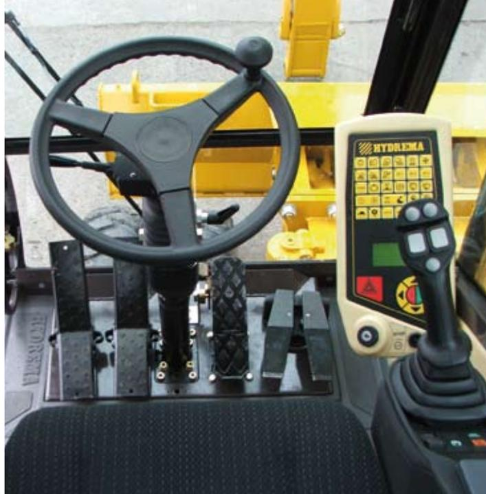
Der Computer informiert den Fahrer auch über eventuell auftretende Systemfehler, z. B. am Motor, und inwieweit sich diese selber beheben lassen, oder ob ein Servicemonteur hinzugezogen werden sollte. Über den Computer wird auch der automatische Wechsel
