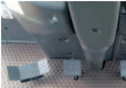
Schwenken mittels Fußpedal für ermüdungsfreies Arbeiten
