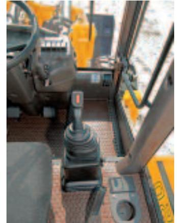
Einfache Bedienung; alle wichtigen Arbeitsfunktionen sind im Joystick integriert
