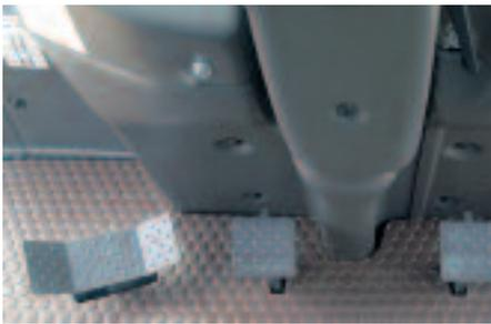
Schwenken mittels Fußpedal für ermüdungsfreies Arbeiten
