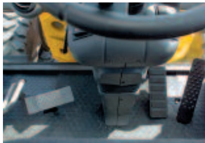
Schwenken mittels Fußpedal für ermüdungsfreies Arbeiten
