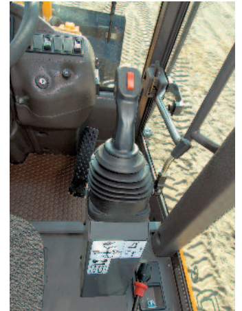
Einfache, intuitive Bedienung; alle Arbeitsfunktionen sind im Joystick integriert
