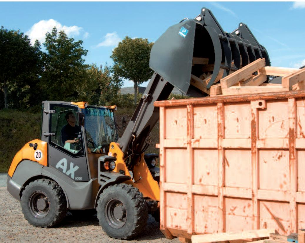
Durch den ASAP-Mono-boom verfügt der Ahlmann AX über hohe Reißkräfte. Seine Z-Kinematik ermöglicht eine exzellente Parallelführung der Anbaugeräte. Insbesondere bei der Verladung von Paletten bedeutet dies eine hohe Sicherheit. Schnelle Kippzyklen und eine optimale Sicht auf die Anbaugeräte machen die tägliche Arbeit effizienter.
