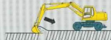
**Löffel richtig füllen** ist leicht, weil bei Simultanbewegungen die Arbeitsausrüstung mit maximaler Kraft besonders präzise bewegt werden kann.
