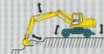
Auch bei **harter Arbeit** steht die Maschine ruhig, da sich trotz unterschiedlicher Grabwiderstände die Geschwindigkeit der Arbeitsausrüstung nicht ändert.
