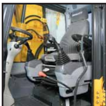
Schuifbereik stoel: 340 mm
