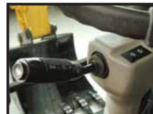
Kantelbaar stuurwiel met verschillende functies
