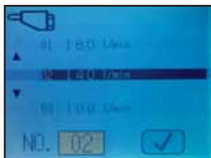
Hydraulische opbrengst algemeen aanpassingsscherm in B (breker)-modus
