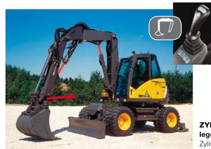
**ZYLINDERKOPPLUNG: Bedienung des Verstellauslegers ohne Verwendung von Fußpedalen** mittels Zylinderkopplung (Mecalac-Patent).
