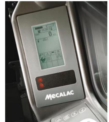
Die hoch auflösende blaue **LCD-Anzeige** ist selbst bei starker Sonneneinstrahlung gut ablesbar und zeigt alle Informationen, die für den optimalen Einsatz des Baggers unverzichtbar sind.
