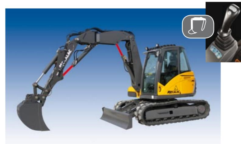
**ZYLINDERKOPPLUNG:** Bedienung des Verstellauslegers ohne Verwendung von Fußpedalen mittels Zylinderkopplung (Mecalac-Patent).
