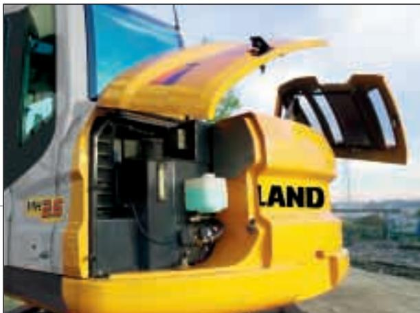
**K**raftstofftank mit Füllstandanzeige.
