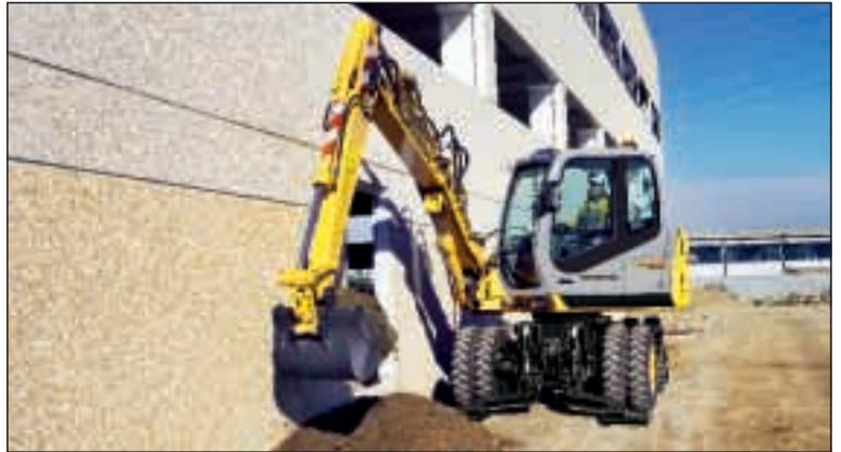
**P**atentierte Sicherheits-Sperrventile an Ausleger- und Löffelstielzylindern sind Standard.
