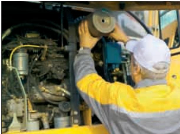
**K**ontrolle von Kraftstoff und Luftfiltern.
