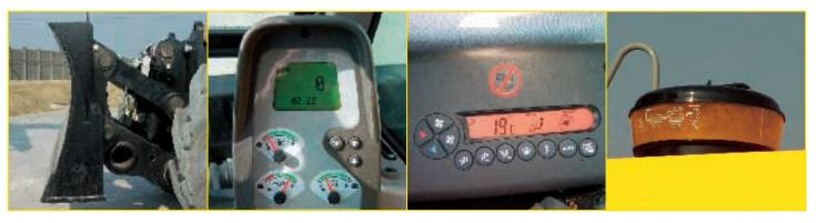
■ NEUES PLANIERSCHILD in Rechteckprofil mit zwei vertikalen Zylindern
