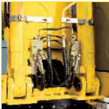
■ NEU KONSTRUIERTE, NEW HOLLAND PATENTIERTE SCHLAUCHBRUCHSICHERUNGEN als Standardausstattung
