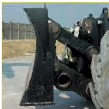
■ Neues **PLANIERSCHILD IN RECHTECKPROFIL** mit zwei vertikalen Zylindern
