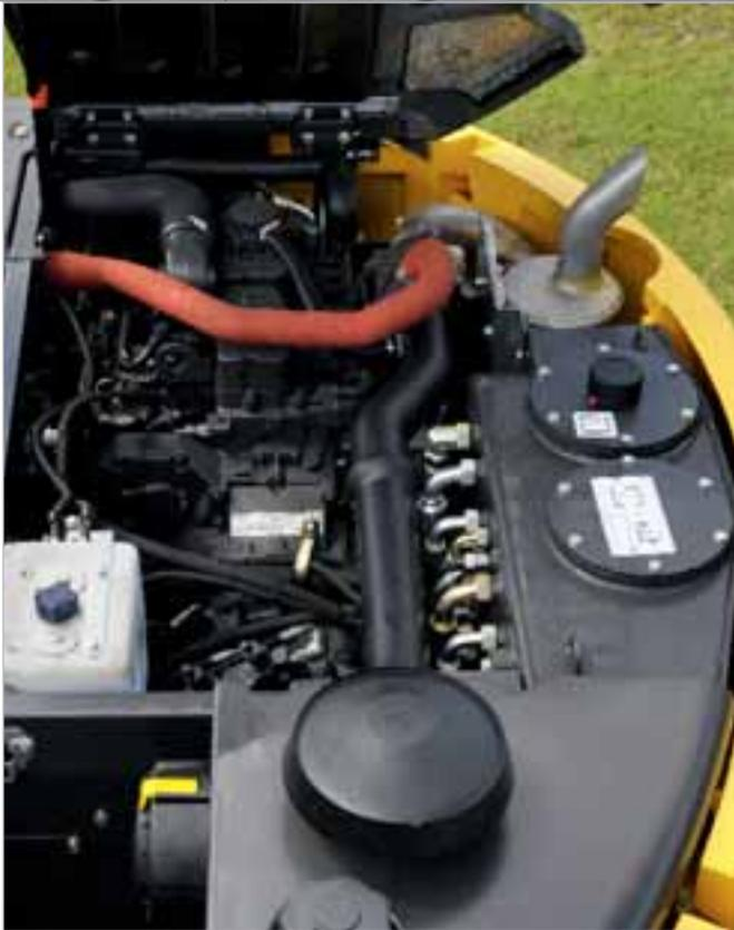
Ein **hydrostatisch betriebener Lüfter**, dessen Drehzahl per Thermostat-Sensor geregelt wird, saugt saubere Außenluft durch einen 3-Seiten-Kühler und sorgt so für eine effizientere Kühlung und gleichzeitig für eine kürzere Aufwärmphase. Daraus ergibt sich eine deutlich geringe Lärmentwicklung. Die niedrigere Drehzahl des Lüfters reduziert außerdem den Kraftstoffverbrauch.
