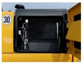
Die Komponenten des Kühlsystems (Lüfter, Hydraulikölkühler und Zwischenkühler) sind parallel angeordnet und erzielen so einen erheblich höheren Wirkungsgrad. Das erhöht die Zuverlässigkeit der Komponenten und erlaubt einen einfacheren Zugang für die Reinigung und Kontrolle.
