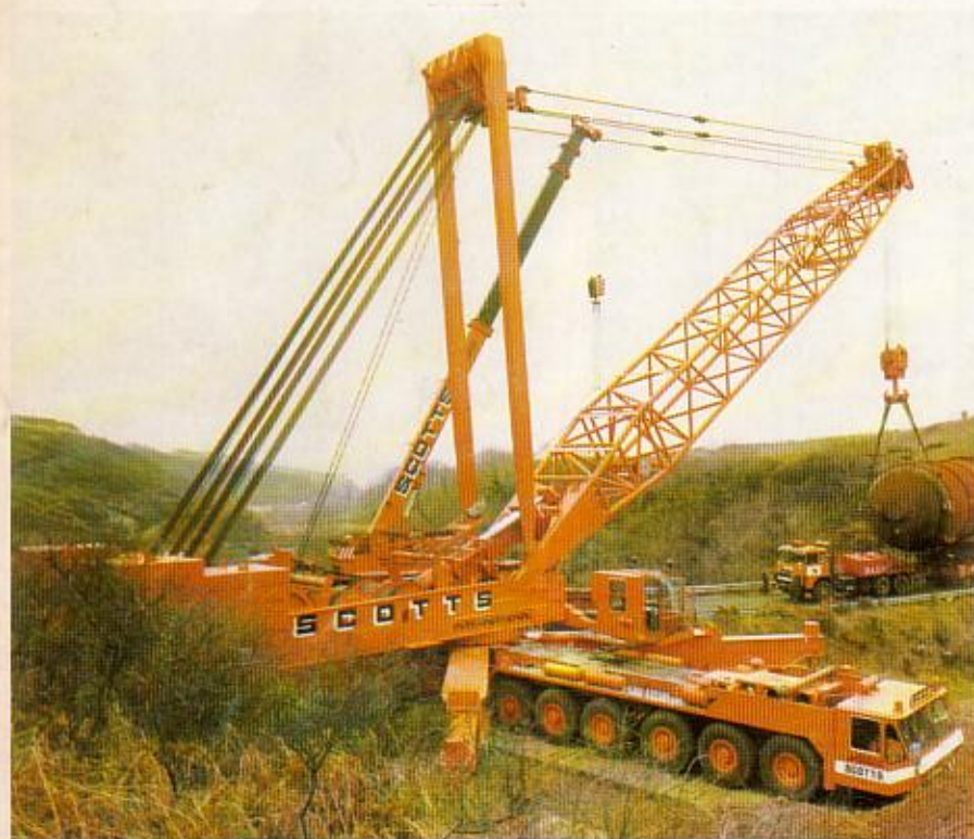
GOTTWALD AK 680-1 mit 650/850 t Tragfähigkeit
