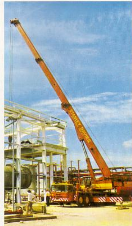
GOTTWALD AMK 200-103 mit 200/230 t Tragfähigkeit
