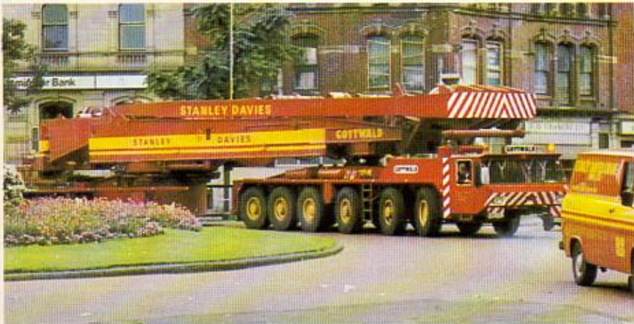
GOTTWALD AK 680 mit 650/850 t Tragfähigkeit
