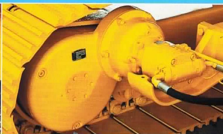
Viel Zugkraft für alle Einsatzzwecke durch den Liebherr-Fahrtrieb. Das bedeutet ein außergewöhnlich starkes Durchzugsvermögen bei schweren Böden. Die integrierte Fahrwerksbremse dient auch als Feststellbremse beim Arbeiten, wobei der Fahrmotor vor Reaktionskräften geschützt wird.
