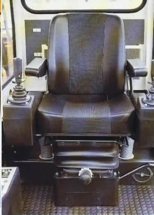
Der perfekt gestaltete Fahrersitz ist dreifach verstellbar. Er ist auf das Fahrergewicht einstellbar und bietet mit der bedienungsgerechten Armlehnensteuerung die Voraussetzung für ermüdungsarmes Arbeiten. Auf Wunsch sind Kopfstütze sowie Sicherheitsgurt erhältlich.
