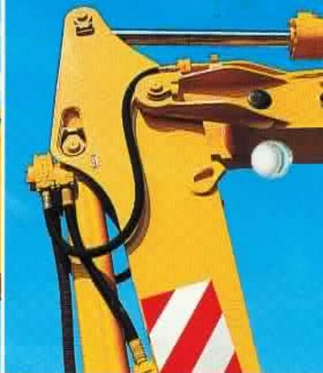
Die Bolzen der Arbeitsausrüstungen sind gehärtet und verchromt. Sie lagern in verschleißarmen Messing- bzw. Stahlbuchsen.
