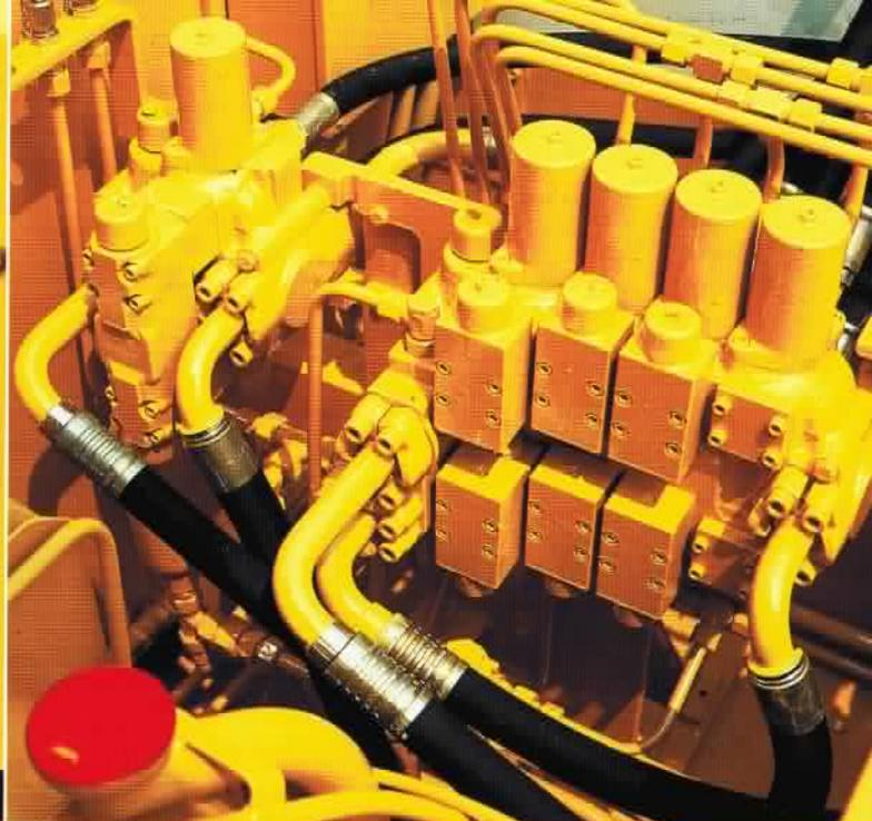
**Die neue Hydro-Tandem-Schaltung des R 912 erlaubt die Ausführung aller Arbeitsbewegungen unabhängig von der Fahrbewegung. Das Schwenkwerk, das eine Vorzugs-schaltung hat, kann gleichzeitig mit jeder Arbeitsaus-rüstung bewegt werden.**
