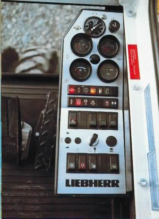
Übersichtlich im Blickfeld des Fahrers: Das moderne Armaturenpult mit den Bedienungs- und Überwachungselementen, Symbole und Leuchten gemäß SAE-Normen.
