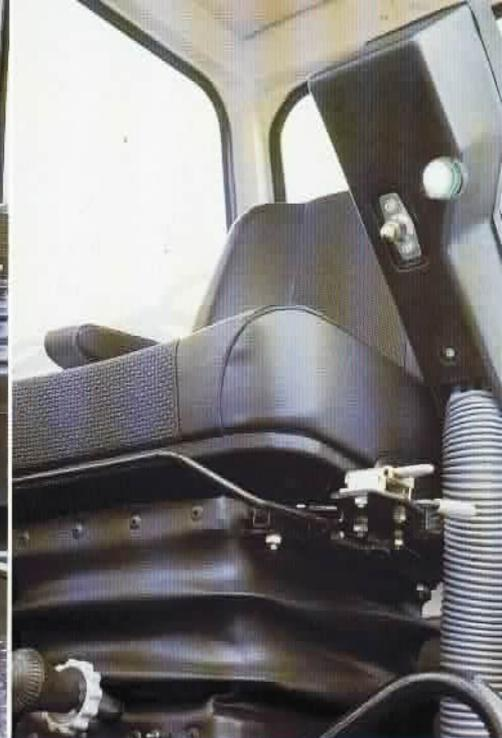
Die linke Armlehne ist zum bequemen Aus- und Einstieg hochklappbar. In diesem Zustand ist die Steuerung automatisch sicherheitsabgeschaltet.
