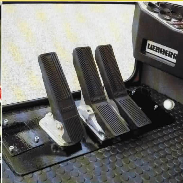
Fahrwerksteuerung beim Raupengerät erfolgt mittig durch Zweipedal-Fußschaltung. Das bringt mehr Beweglichkeit bei schwierigen Einsätzen, da das Schwenkwerk und jede Arbeitsausrüstung gleichzeitig betätigt werden können.
