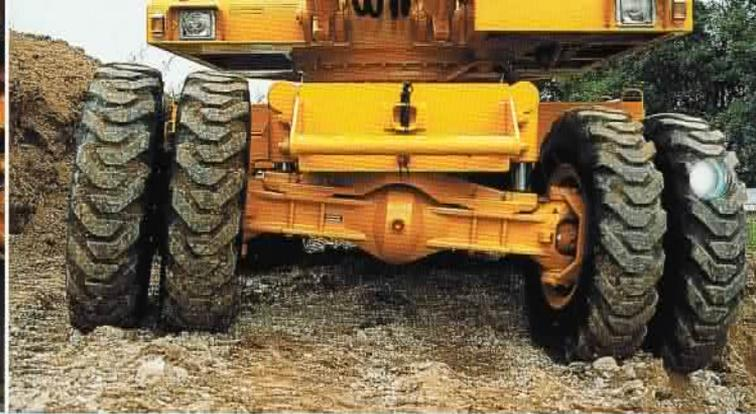
Die 30 t-Planetenachse wurde von Liebherr speziell für diesen Bagger entwickelt. Der günstige Wenderadius (innen 3,9 m und außen 7,0 m) macht den Bagger extrem beweglich und zum Beispiel für den Einsatz in Engstellen geeignet.
