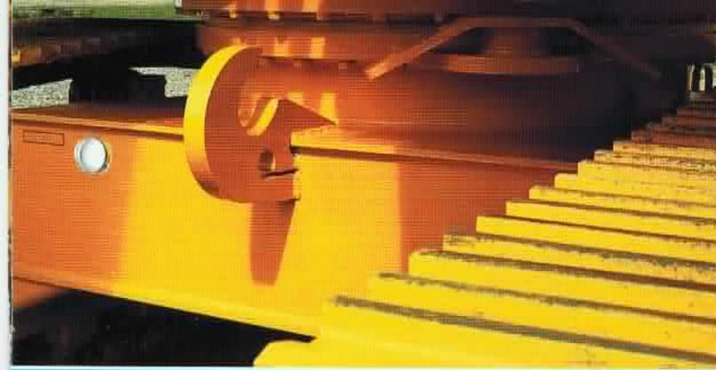
Der großdimensionierte Drehkranz ist innenverzahnt und so vor Schmutz und Beschädigungen geschützt. Die starke Verzahnung und die extrem belastbare Kugellaufbahn bewirken eine besonders lange Lebensdauer.
