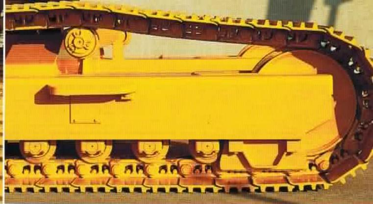
Das Leitrad mit dem hohen Mittelsteg erzielt eine präzise Führung der Laufwerkskette. Die serienmäßige Kettenführung am LC- und HD-Unterswagen ergibt zusätzliche Sicherheit beim Drehen im schwierigen Gelände.
