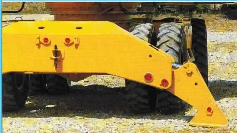
Pratzenabstützung durch Einzelzylinder als Zweipunkt- oder Vierpunkt-Ausführung. Die Einzelzylinder sind mit Rückschlagventilen gesichert. Pendelfüße ermöglichen eine günstige Anpassung an den Untergrund.
