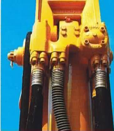
Umschaltmöglichkeit serienmäßig von Tieflöffel auf Greifer; Dadurch kein Leitungsaustausch beim Ausrüstungswechsel.
