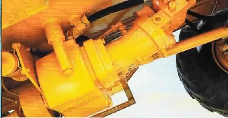
Allradantrieb durch Verstellölmotor mit großem Geschwindigkeitsbereich und mehr Zugkraft. Einfaches Umschalten auf Gelände- oder Straßengang. Fahrbremsventil ermöglicht bremsfreie Talfahrt, ohne daß der Ölmotor überdreht wird.
