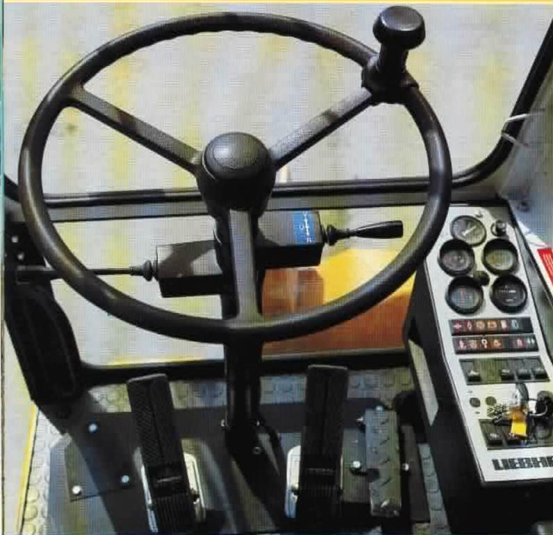
Die Fahrtrichtung wird durch einen Schalthebel elektrisch vorgewählt, die Geschwindigkeitsregulierung erfolgt stufenlos über ein Pedal. Die Lenkung arbeitet vollhydraulisch mit Proportionalcharakteristik.
