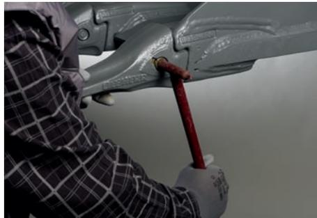
Blockierteil mit dem Arretierschlüssel entriegeln
