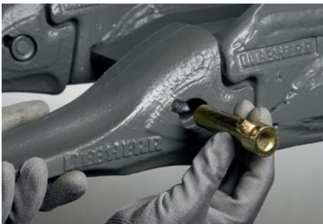
Sicherungsbolzen in die Halterung schieben
