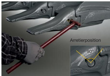
Sicherungsbolzen mit dem Arretierschlüssel verriegeln
