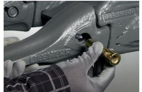
Sicherungsbolzen aus der Halterung entfernen
