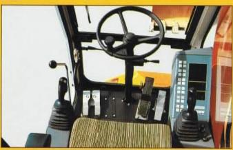
Separater Servo-Steuerkreis zur Proportional-Steuerung der einzelnen Bewegungen.
