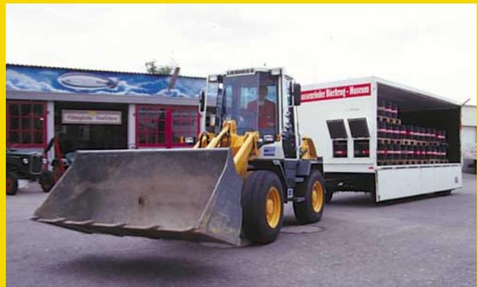
Die Brauerei Ott konnte den Stereolader durch die Wahlmöglichkeit zwischen Parallel- und Z-Kinematik genau auf ihre Einsatzanforderungen anpassen. Die im Hubgerüst serienmäßig integrierte Schnellwechseinrichtung ermöglicht einen raschen und einfachen Wechsel zwischen Ladeschaufel, Kehrmaschine und Ladegabel.
