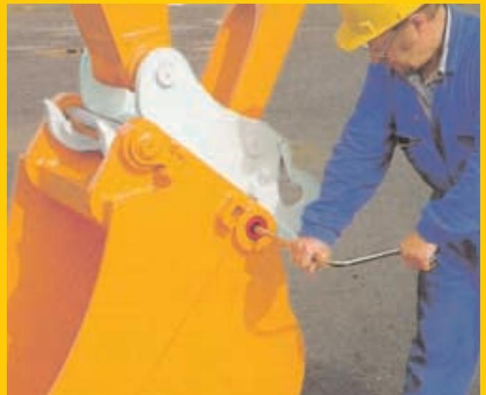
Liebherr Schnellwechsel-Adapter hydraulisch
