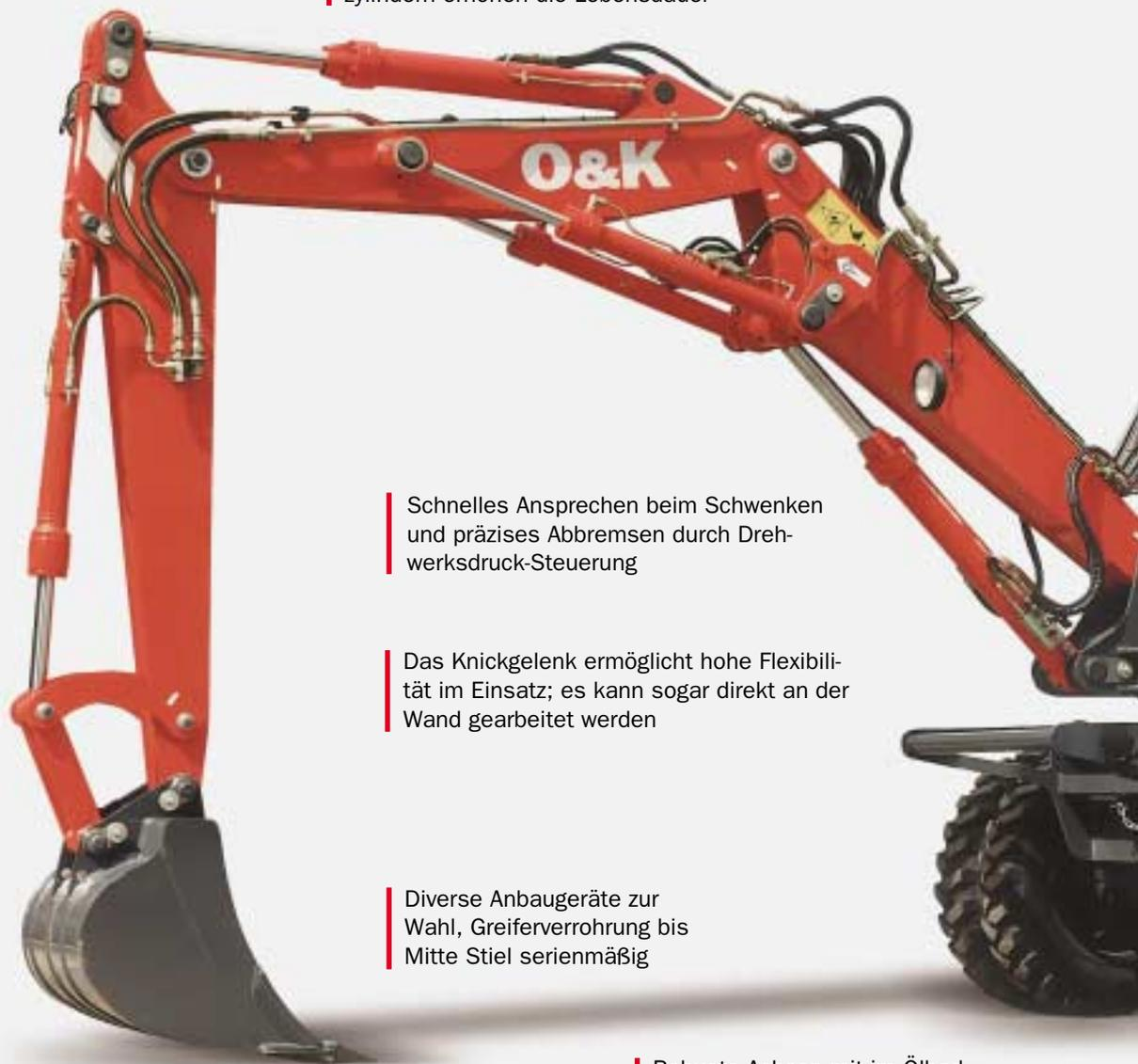
Schnelles Ansprechen beim Schwenken und präzises Abbremsen durch Drehwerksdruck-Steuerung
