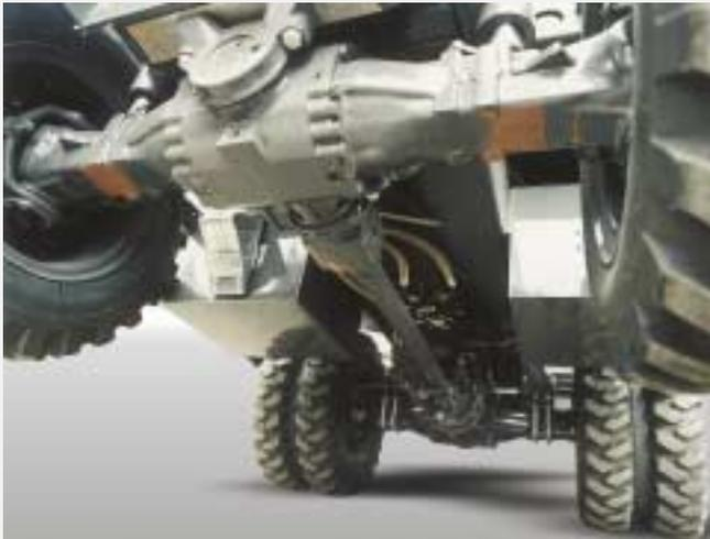
Sicher durch jedes Gelände dank hoher Bodenfreiheit. Die Vorderachse ist pendelnd gelagert ( $14^\circ$ ) und kann in jeder Stellung hydraulisch gesperrt werden.
