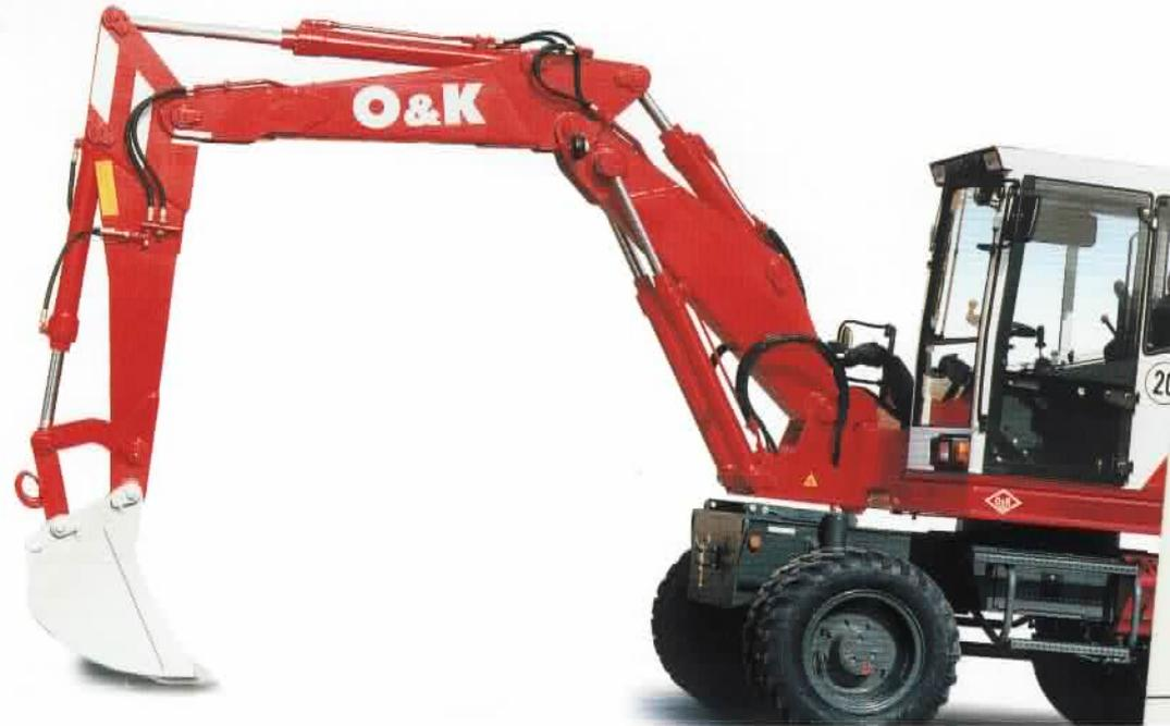
Das Knickgelenk erhöht die Einsatzstärke gerade auf engstem Raum. Die Ausrüstung kann beidseitig bis zu 65° versetzt werden, so daß Arbeiten direkt vor Mauern, Hecken oder Böschungen problemlos möglich ist. Diese Einsatzvielfalt wird durch die Verstellrüstung weiter gesteigert. Sie erzielt große Reichweiten und erlaubt zusätzlich das Arbeiten unmittelbar vor dem Gerät.
