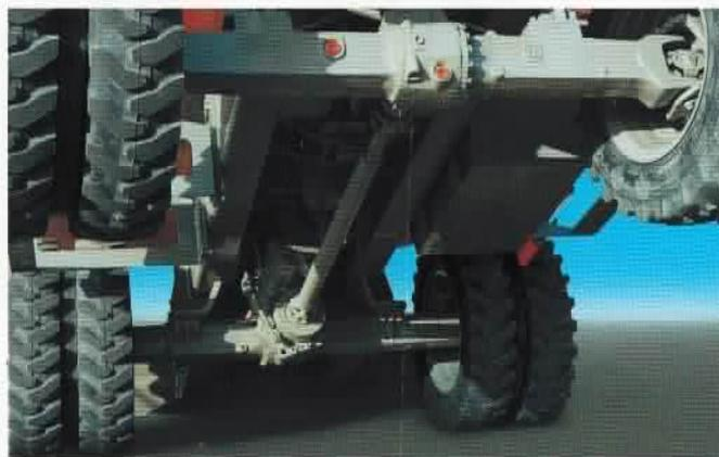
Solide Rahmenkonstruktion und pendelnd gelagerte Planetenbaggerachse für gute Geländegängigkeit.
