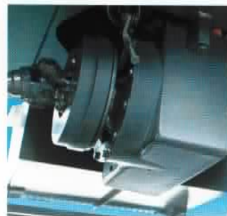
Der Antrieb im Regelfahrmotor: zwei mechanische Schaltstufen sorgen für ideale Anpassung bei Straßenfahrt, im Gelände und bei Steigungen.
