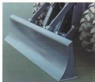
Arbeitsgerät und Abstützvariante: das Planierschild.
