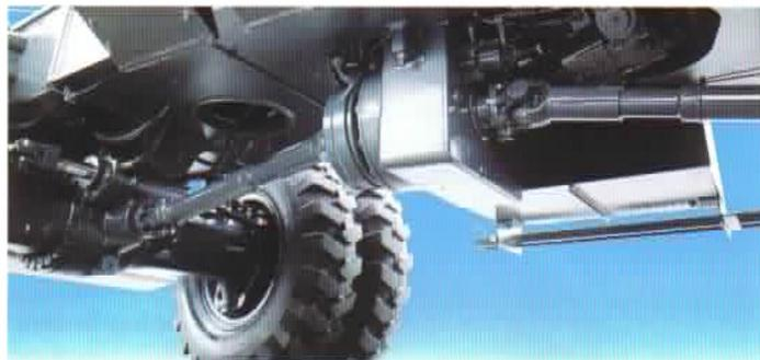
Der Regelfahrmotor – zwei Schaltstufen sorgen für ideale Anpassung bei Gelände- und Straßenfahrt.
