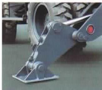
2-Punkt- oder 4-Punkt-Pratzenabstützung für besseres Ausrichten des Baggers – solide Basis auf jedem Grund.
