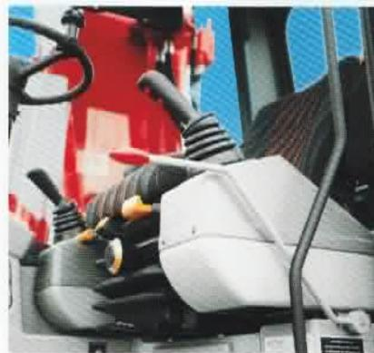
Die individuell einstellbaren, ergonomisch gestalteten Vorsteuerhebel mit integrierten Druckknöpfen für Sonderfunktionen sind griffgünstig in den Seitenkonsolen platziert.
