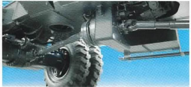
Der Regelfahrmotor – zwei Schaltstufen sorgen für ideale Anpassung bei Gelände- und Straßenfahrt.
