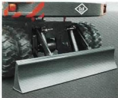
Das Planierschild erhöht die Standruhe des Mobilbaggers spürbar. Eine sichere „Stütze“.
