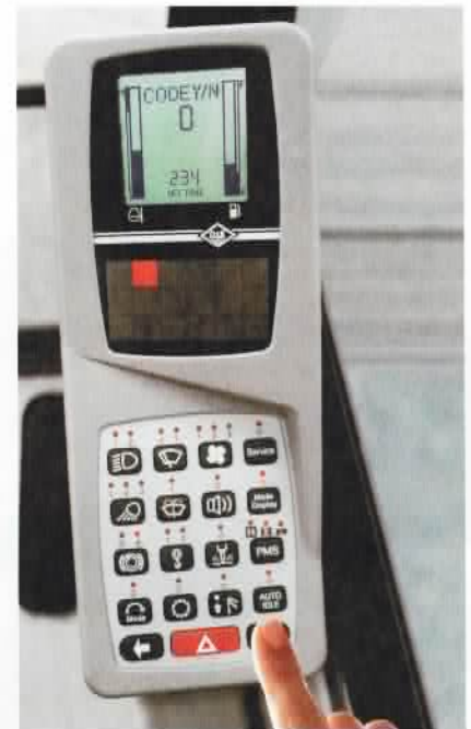
Moderne Chip-Technologie sichert einen optimalen Informationsstand über die jeweils aktuellen Betriebsdaten. Durch Abgleichen mit den eingegebenen Sollwerten werden Abweichungen frühzeitig erkannt – bevor sie sich zu Störungen entwickeln.
