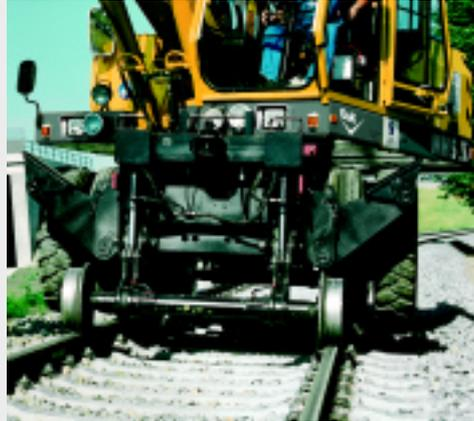
eine Abschlepp-Position gebracht werden kann. Außerdem kann der Bagger durch einen konstant niedrigen elektrischen Widerstand zwischen den Führungsrädern jederzeit vom nächsten Stellwerk geortet werden.
