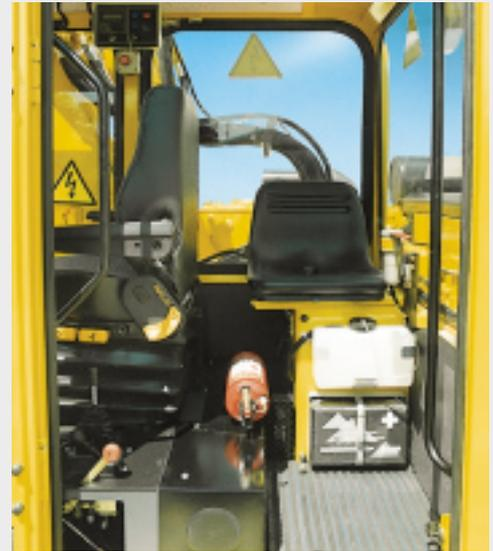
Geräumiger Lotsenplatz für den „2. Mann“, der im Notfall bei Überführungsfahrten auf den Gleisen das Gerät zum Stillstand bringen kann.
