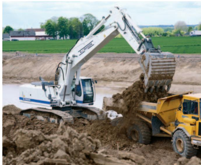
Litronic durch den Liebherr 6-Zylinder Reihenmotor D 936 L, der erstmalig in eine Erdbewegungsmaschine eingebaut wird. Seine Leistung beträgt 240 kW/326 PS. Dieser Motor erfüllt schon jetzt die ab dem 1. 1. 2006 geltenden gesetzlichen Abgasnormen nach TIER III, sowie die gültigen Schallgrenzwerte. Die Arbeitsausrüstung besteht aus einem 7,6 m langen Monoblockausleger, einem 2,9 m Löffelstiel und einem 2,8 m<sup>3</sup> fassenden Tieflöffel. Das Einsatzgewicht beträgt ca. 50 t.
