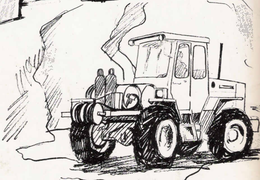
SERVICEVOERTUIG met lier-, vet- en olie-uitrusting
