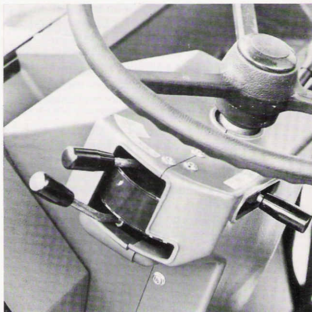
▲ Moderne, leichtgängige 2-Hebel-Tippschaltung
