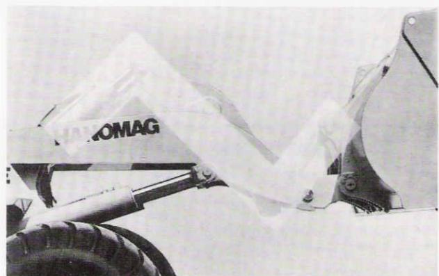
▲ Hohe Reißkräfte durch Z-Kinematik
