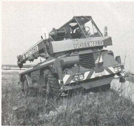
GOTTWALD Teleskop-Autokran AMK 46-21 mit 25/27,5 t Tragfähigkeit
