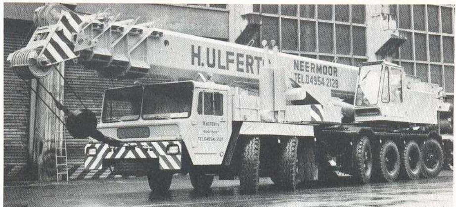
GOTTWALD Teleskop-Autokran AMK 125-63 mit 100/125 t Tragfähigkeit
