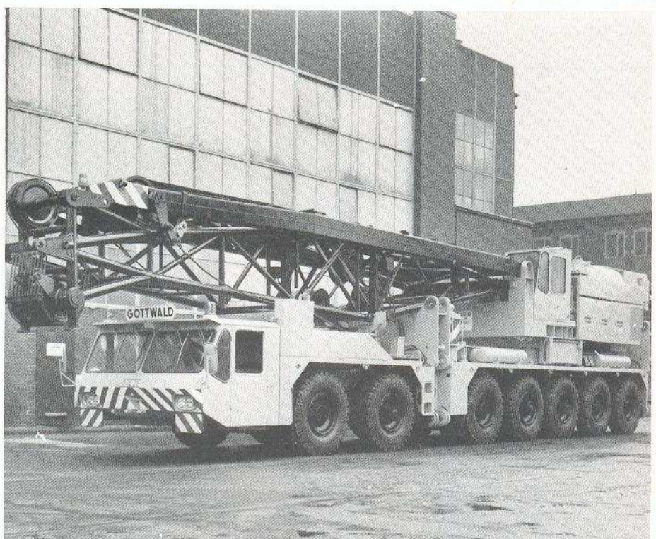
GOTTWALD Gittermast-Autokran AK 210-73 mit 180/225 t Tragfähigkeit
