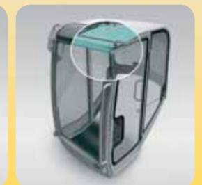
4 Beide Scheibenteile werden unter dem Kabinendach verwahrt. Sie müssen weder herausgenommen noch irgendwo gelagert werden. Die Beschädigungsgefahr ist gebannt.
