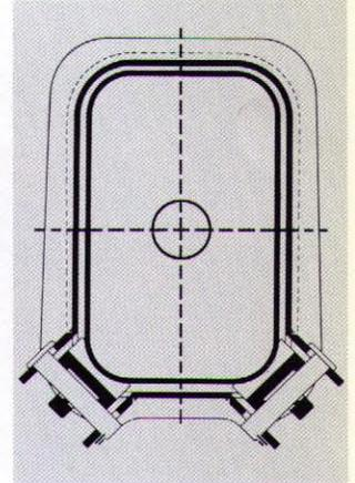
Der Ausleger-Arm im gerundeten Demag Ovaloid-Profil. Niedriges Gewicht und hohe Steifigkeit. Das wartungsfreie Kunststoff-Gleitschuhsystem zentriert alle Teleskope.
