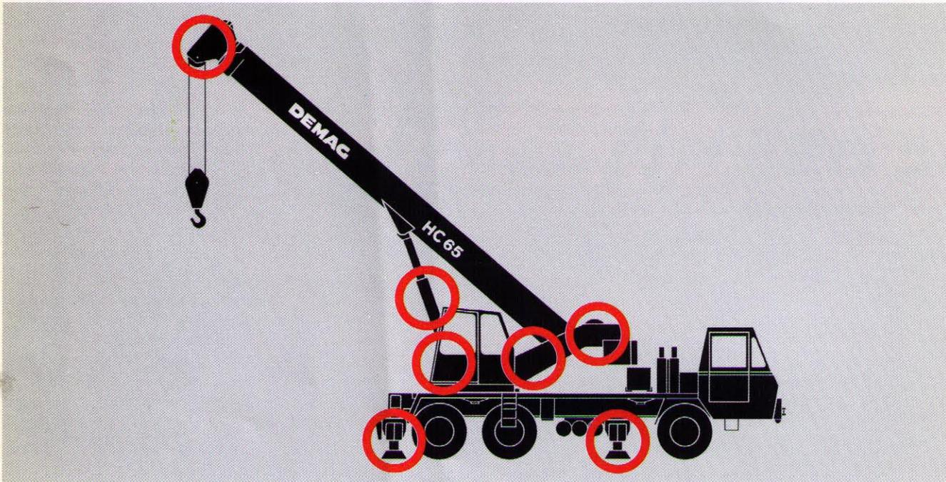
Serienmäßig bietet der Demag-Teleskopkran HC 65 ein ganzes Paket von Sicherheits-Einrichtungen. Druckbegrenzungs-Ventile vermeiden die Überlastung der hydraulischen Systeme. Der Lastmomentbegrenzer (LMB) kontrolliert vollautomatisch. Wird das Lastmoment unzulässig vergrößert,
