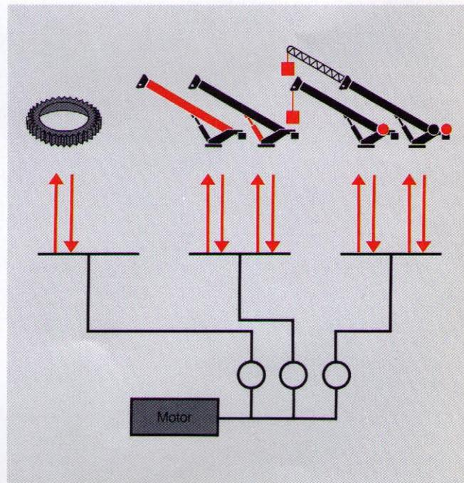
Drei Hydraulik-Pumpen. Das bedeutet drei unabhängige Arbeits-Funktionen, die sich gleichzeitig bedienen lassen. Also schnellere, flüssigere Kranbewegungen. Der Hydraulik-Schnellgang beschleunigt die Arbeit von Hubwerk, Wippe und Teleskop. Der separate Drehwerkskreis erlaubt ein feinfühliges und kontrolliertes Drehen, wahlweise auch durch Fußbetätigung gesteuert.
