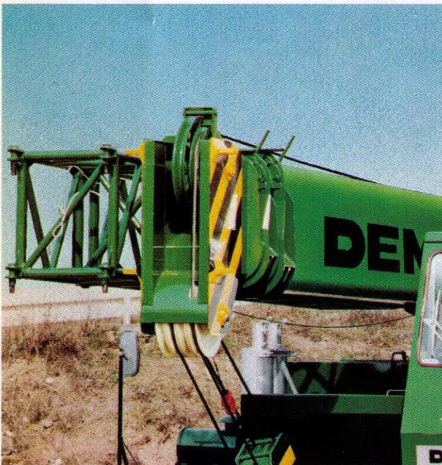
Der Hubenschalter verhindert Beschädigungen durch Anschlagen der Unterflasche am Rollenkopf. Als Sondereinrichtung sichert ein Senkenschalter das Seil gegen Abreißen von der Trommel und Beschädigung durch falsches Aufspulen.
