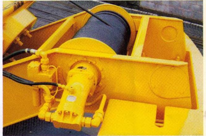
Die Hubwerkseinheit mit Hydromotor, Planetengetriebe und Lamellenbremse liegt hoch und sorgt so für eine gradlinige Seilführung. Serienmäßig vorgeplant: der Einbau einer zweiten Hubwerkswinde für den Zwei-Seil-Betrieb.
